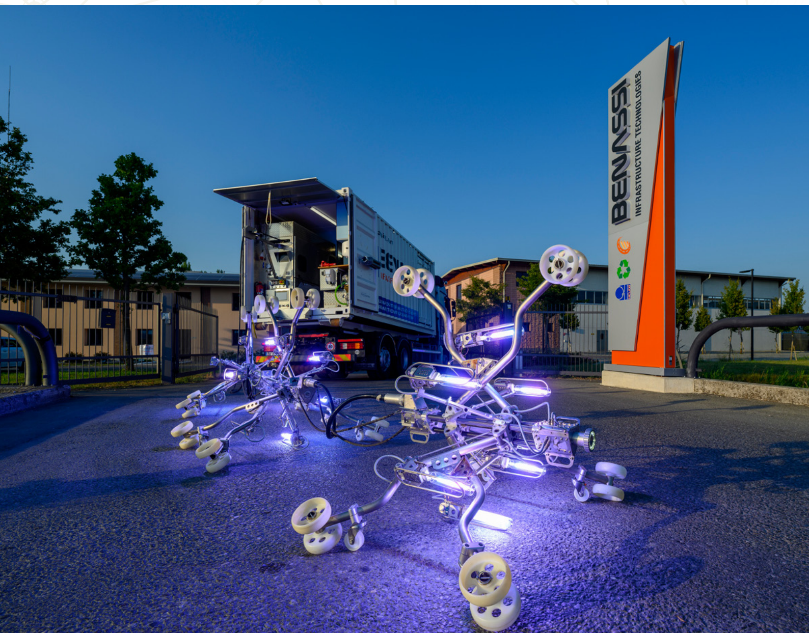
sede Benassi Srl e unità di polimerizzazione a raggi UV con cavo da 300 m e potenza d'irraggiamento pari a 36.000 W
