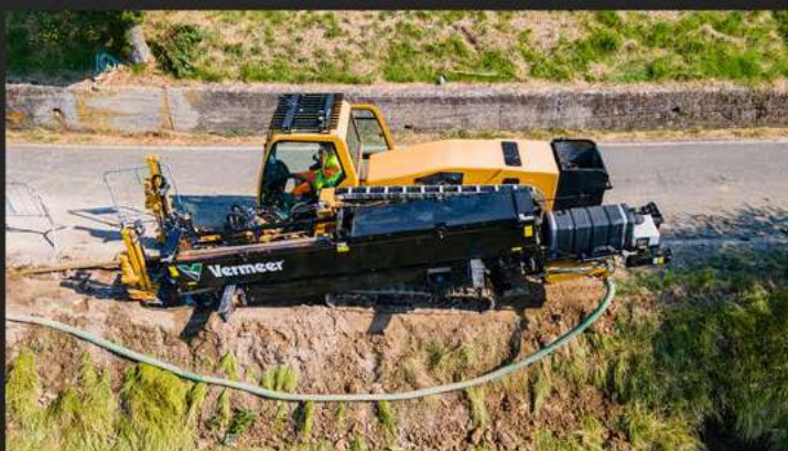
PERFORATORE ORIZZONTALE CONTROLLATO VERMEER
