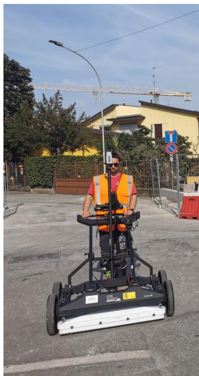
Sistemi GEORADAR (georadar ad array)
