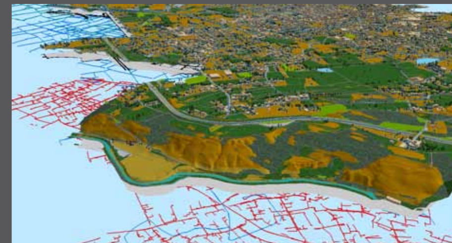
Restituzione tridimensionale con reti del sottosuolo da elaborazione GIS
